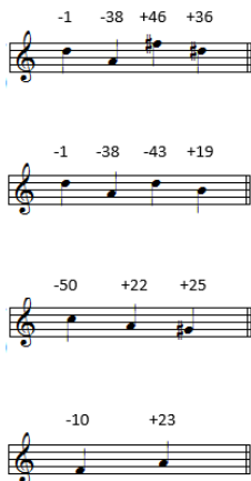
Fig. 16: Alturas con desviaciones en cents de los sonidos en regimen 1 de los tubos 1, 2 y 3 cerrado
