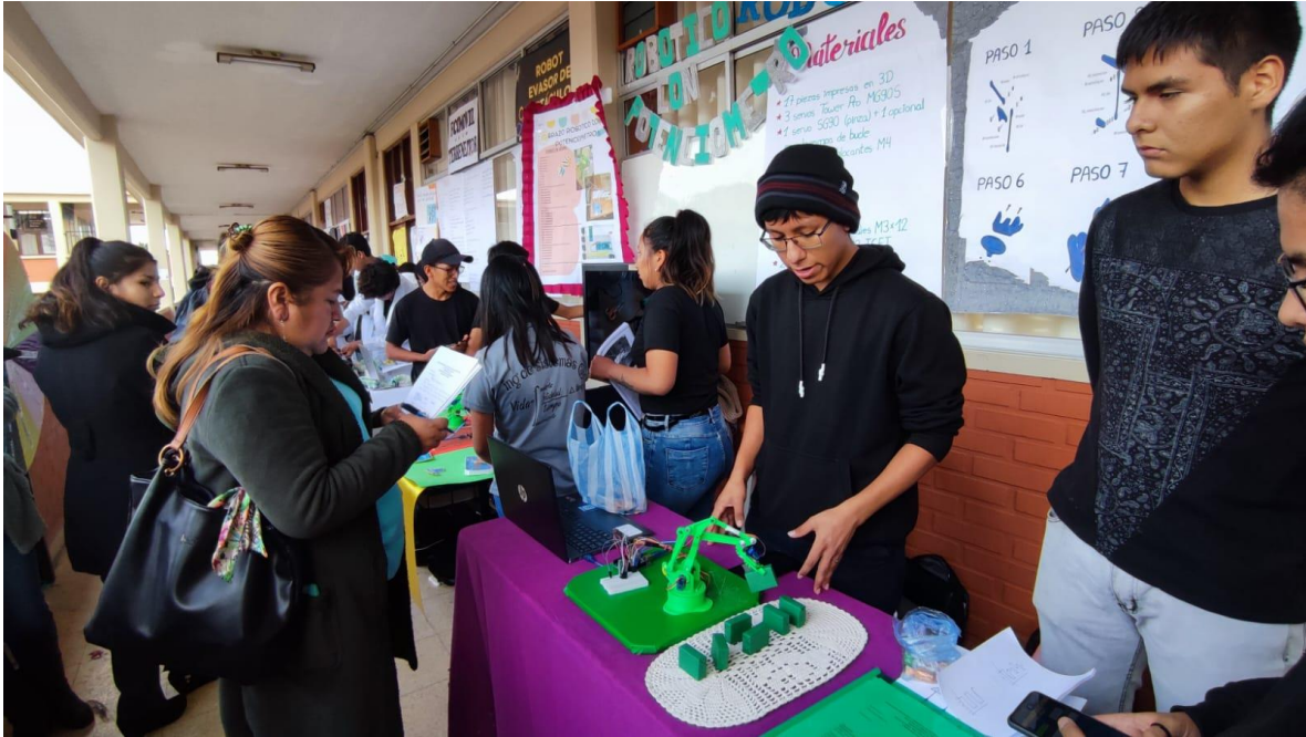
Brazo robótico, diseñado y fabricado en el Taller de Física y controlado por sensores y por placa arduino (Tribunal examina el trabajo)
